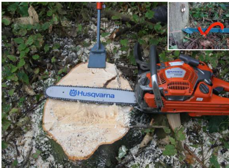
Een velhevel kan als hulpmiddel worden ingezet om de boom veilig over het 'dode punt' te hevelen
