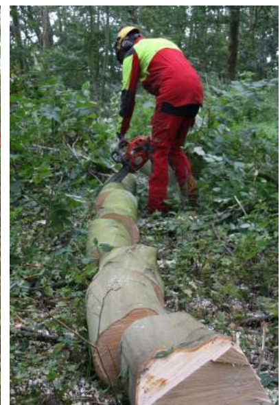
Zaag de stamstukken nu helemaal los (duwende of trekkende ketting)
